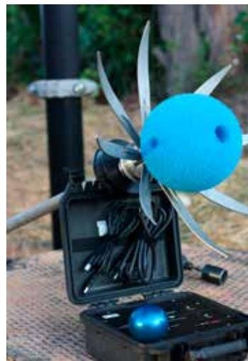
*Fernwärmerohrleitungen führen sehr heißes Wasser. Daher stellen sie eine Herausforderung für Techniken zur Lecksuche dar. Die SmartBall-Plattform wurde in Fernwärmerohrleitungen mit Temperaturen von bis zu 105°C getestet und hält diesen Temperaturen problemlos stand.*
