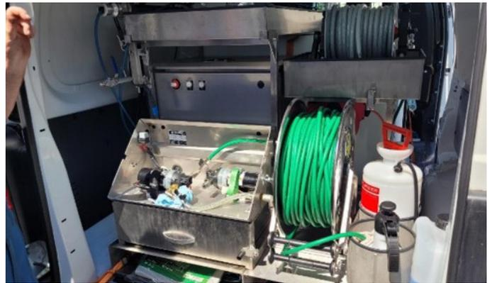
Moosfrei® dispose de plus de cinq fourgons de traitement équipés de pompes à membrane industrielles de la série Triplex de Flojet, et chaque pompe peut être rechargée pendant le transport pour éliminer les temps d'arrêt inutiles.
