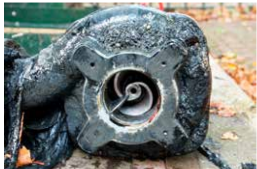
De Flygt Concertor is voorzien van een ‘Hard Iron’ waaier. Dit harde materiaal is heel goed bestand tegen slijtage, wat ervoor zorgt dat de levensduur tot wel drie keer hoger is ten opzichte van gebruikelijk toegepaste waaiers.
