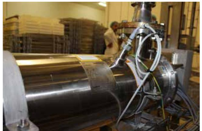
UV-Anlagen werden im Lebensmittelbereich immer mehr geschätzt, um Bakterien zu eliminieren und den Zusatz von chemischen Substanzen zu minimieren
