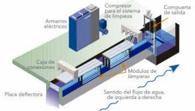
Configuración típica de un sistema UV de canal abierto
