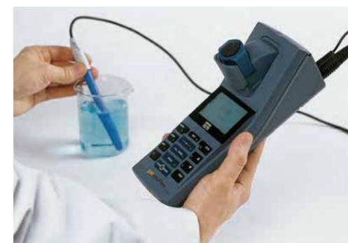
El **colorímetro pHotoFlex pH** permite la conexión de un sensor de pH externo. No sólo permite obtener mediciones del pH, sino también una lectura de amonio directa compensando la exactitud de la lectura del pH y temperatura.
