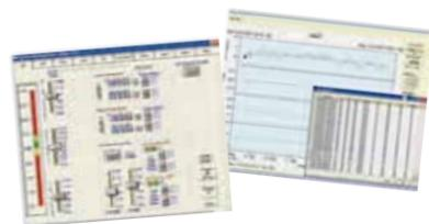
Ejemplo del sistema de manejo en pantalla 5200A que muestra los puntos de referencia para el pH. Los set points para 5400 y 5500D parecen similares. Usted puede ver su información de forma instantánea en tablas o en formato de gráficos.
