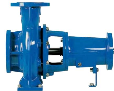
Cuerpo de la bomba moldeada en hierro y con acero inoxidable AISI 316L, impulsor soldado con tecnología láser. Conveniente para bombeos de líquidos fríos y calientes y moderadamente agresivos. Bombas más grandes utilizan impulsores más duraderos moldeados en hierro,
