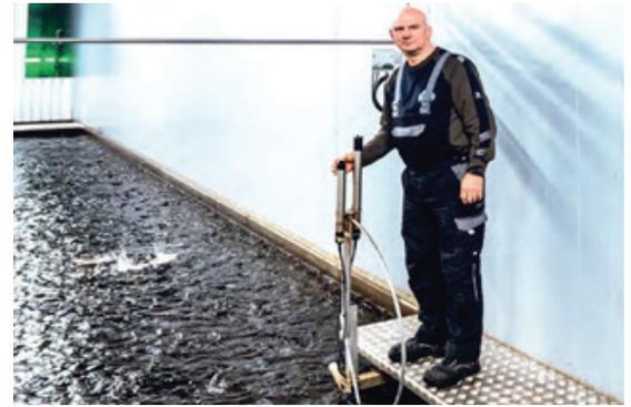
*El responsable de producción de FREA, Egon Folmer, muestra uno de los soportes giratorios especiales en el que se montan el sensor digital de pH SensoLyt® 700 IQ y el sensor de oxígeno óptico sin calibración FDO® 700 IQ.*
