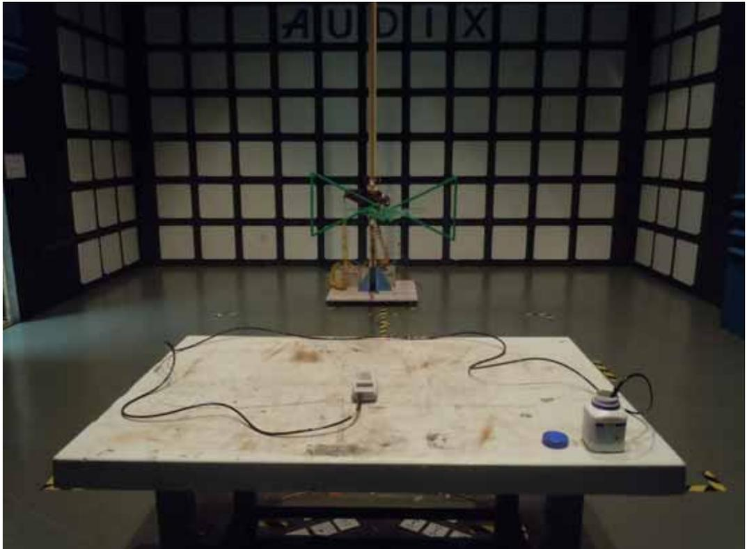
*BACK VIEW OF RADIATED EMISSION TEST*
