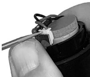
3. Attendre au moins 90 secondes avant d'insérer une nouvelle batterie. Le transducteur doit être réinitialisé avant de raccorder une nouvelle batterie.
