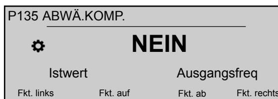
Dieser Parameter aktiviert den Abwärtskompatibilitätsmodus: bei Einstellung auf JA, wird der HYDROVAR gezwungen, in einer Anwendung mit mehreren Pumpen zu arbeiten und dabei wie ein Modell der früheren HYDROVAR-Generation (HV 2.015-4.220) zu wirken und zu kommunizieren.
