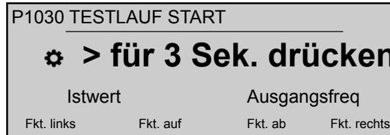
Führt einen manuellen Testlauf für die Einheit durch P1025 **AUSWAHL** ausgewählt wurde: diese Funktion gilt auch für Pumpen mit fester Drehzahl im Modus „Kaskadenrelais“.
