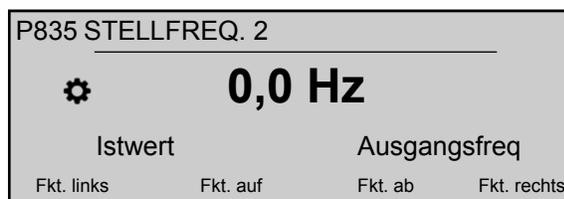
Stellen Sie die erforderliche Frequenz 2 für den Modus „Stellantrieb“ ein (mögliche Einstellung 0,0 Hz - P245 **Max. Frequenz**).
