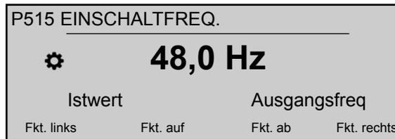
Die nächste Pumpe startet, sobald dieser Wert erreicht ist und der Systemdruck unter die Differenz ( P02 **SOLLWERT** - P510 fällt **ABSENKWERT**).
