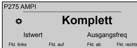
Sobald das **AMPI**-Verfahren aktiviert wurde (wenn entweder die Option „Komplett“ oder „Reduziert“ ausgewählt ist), dauert die Identifizierung des Motors bis zu 3 Min.: in diesem Zeitraum verhindert der HYDROVAR sämtliche Aktionen des Benutzers (die Meldung „Läuft“ auf der Anzeige, die Drucktasten sind deaktiviert).
