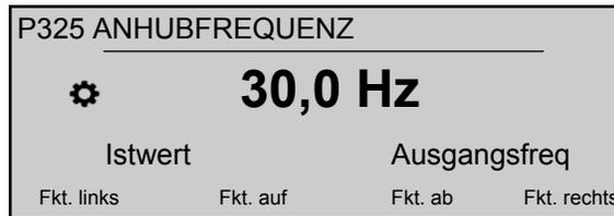
Die richtige Frequenz liegt vor, wenn die Pumpe den Solldruck bei einem Null-Durchfluss erreicht. Dies kann mithilfe von P305 **JOG** ermittelt werden.
