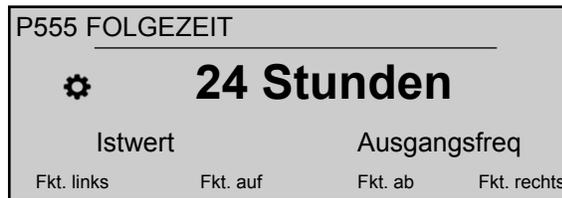
Dieser Parameter stellt das Umschaltintervall für die zyklische Umschaltung ein: er ermöglicht das automatische Umschalten der MASTER-Pumpe und der Hilfspumpen. Sobald die Schaltzeit erreicht ist, wird die nächste Pumpe zum MASTER und der Zähler startet erneut; dadurch werden ein gleichmäßiger Verschleiß und eine ähnliche Betriebszeit aller Pumpen gewährleistet. Das Umschaltintervall ist aktiv, solange der MASTER nicht stoppt.
