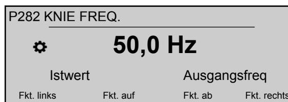
Dieser Parameter (Standardwert 50 Hz, mögliche Einstellung 30,0-90,0 Hz) legt die Kniefrequenz fest, bei der der HYDROVAR seine maximale Ausgangsspannung generiert. Stellen Sie diesen Wert bei Standardanwendungen auf die Nennfrequenz des Motors ein.
