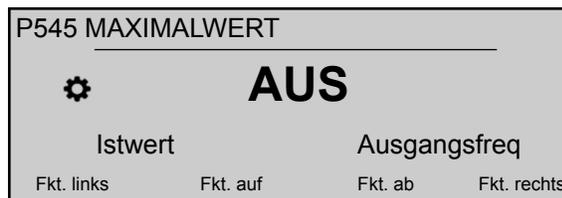
Dieser Parameter schützt das System vor Überdruck, falls der HYDROVAR falsch parametrierung wurde: wenn dieser ausgewählte Wert erreicht wird, erfolgt eine sofortige Abschaltung der Folgepumpen.
