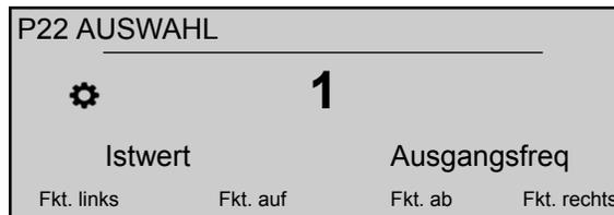
Wenn P105**BETRIEBSART** auf **Kask.Seriell** oder **Kask.Sync.** eingestellt ist, wird mit dem für P22 ausgewählten Wert die Adresse der **AUSWAHL**-Einheiten festgelegt.HYDROVAR
