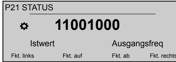
wobei der Status von allen (max. 8) angeschlossenen Einheiten angezeigt wird (mit 1=aktiviert/0=deaktiviert).
