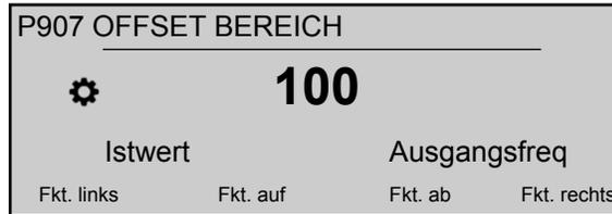
Stellen Sie die Darstellung des Sensorbereichs ein: der Wert ist abhängig vom maximalen Bereich des angeschlossenen Offset-Sensors. Ein höherer Offset-Bereich hat eine höhere Auflösung des Signaleingangs.
