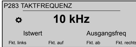
HYDROVAR kann die Taktfrequenz automatisch reduzieren und die Kriterien für die Leistungsreduzierung anwenden. Mögliche Einstellungen sind:
