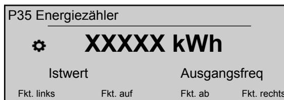
Informationen zum Zurücksetzen des Zählers finden Sie unter den Angaben für Parameter 1140 **KWH ZÄHL LÖSCH**.**KWH ZÄHL LÖSCH**
