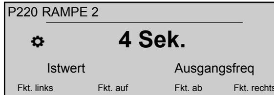
Dieser Parameter passt die schnelle Tiefauframpe an und beeinflusst die Regelung der Pumpe; die Rampe ist abhängig vom HYDROVAR-Typ und vom Pumpentyp.
