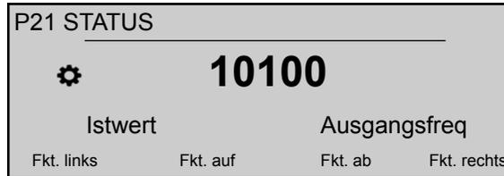
wobei (HYDROVAR verfügt über eine zusätzliche Premium Card) der Status der 5 Relais-Schaltkontakte angezeigt wird. (mit 1=aktiviert/0=deaktiviert).
