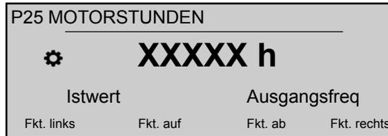
Informationen zum Zurücksetzen der Zahl finden Sie unter den Angaben für Parameter 1130 **MOTOR H LÖSCH** **MOTOR H LÖSCH**
