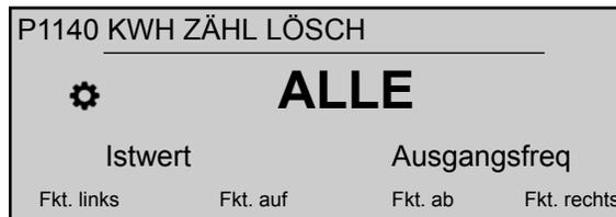
Wird zum Löschen des Kilowattstunden-Zählers verwendet; entweder (1-8) für eine bestimmte Einheit oder „ALLE“ für alle Geräte in „Kaskade seriell“ oder „Synchron“.
