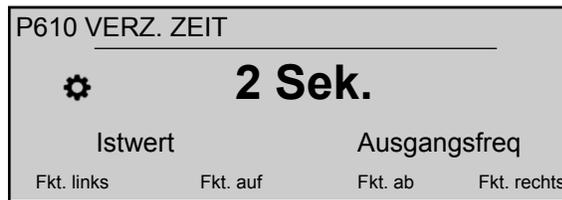
Wählt die Verzögerungszeit der Förderschwelle aus: schaltet den HYDROVAR ab, wenn der Istwert auf unter P605 fällt oder ein Wassermangelschutz (an den Anschlüssen X1/16-17) geöffnet wird.**FÖRDERSCHWELLE**
