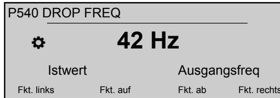
Er wird zum Schutz des Systems vor Druckschlägen verwendet. Bevor der MASTER eine neue Folgepumpe startet, fällt dieser auf diese Frequenz ab. Anschließend (sobald die Frequenz erreicht ist) wird die Folgepumpe gestartet; an diesem Punkt kehrt der MASTER-Inverter wieder in den Normalbetrieb zurück.
