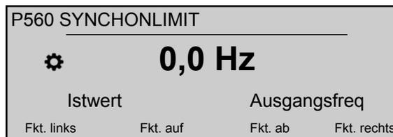
Dieser Parameter stellt den Frequenzgrenzwert ein: die erste Folgepumpe wird abgeschaltet, wenn die Frequenz diesen Parameterwert unterschreitet.
