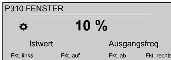
Dieser Parameter (Standardwert 10 %, mögliche Einstellung 0-100 %) legt den Bereich für die Rampensteuerung fest; von langsam zu schnell.
