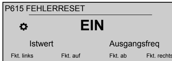
Wählt das automatische Zurücksetzen von Fehlern aus; ein manuelles Rücksetzen kann durch Betätigen eines externen EIN/AUS Kontaktes an Klemmen X1/18-19 (externe Freigabe) durchgeführt werden. Mögliche Einstellungen sind:
