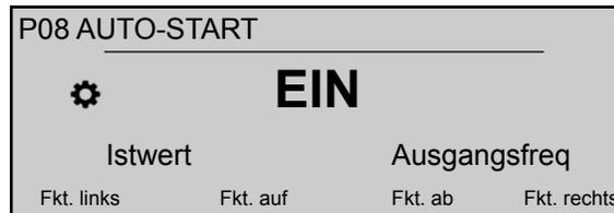
Ist **AUTO-START = Ein**, dann startet der HYDROVAR automatisch (falls Bedarf besteht) nach einer Unterbrechung der Spannungsversorgung.
