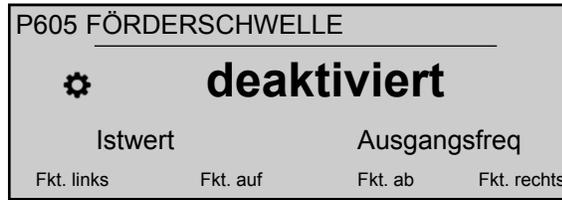
Wählt den Mindestschwellenwert aus: wenn ein eingestellter Wert von > 0,00 nicht innerhalb der P610VERZÖGER.ZEIT**VERZ. ZEIT** erreicht wird, stoppt der HYDROVAR (Fehlermeldung: **FÖRDERSCHWELLEMIN.GRENZW.**
