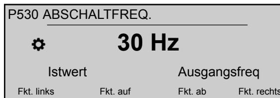
Er stellt die Frequenz zum Ausschalten der Pumpen mit fester Drehzahl ein. Wenn der MASTER-Inverter diese Frequenz für einen längeren als den in P535 **ABSCHALTVERZ.** ausgewählten Zeitraum unterschreitet und der Systemdruck höher als P03 **SW EFFEKTIV** ist, stoppt der MASTER eine andere Folgepumpe.
