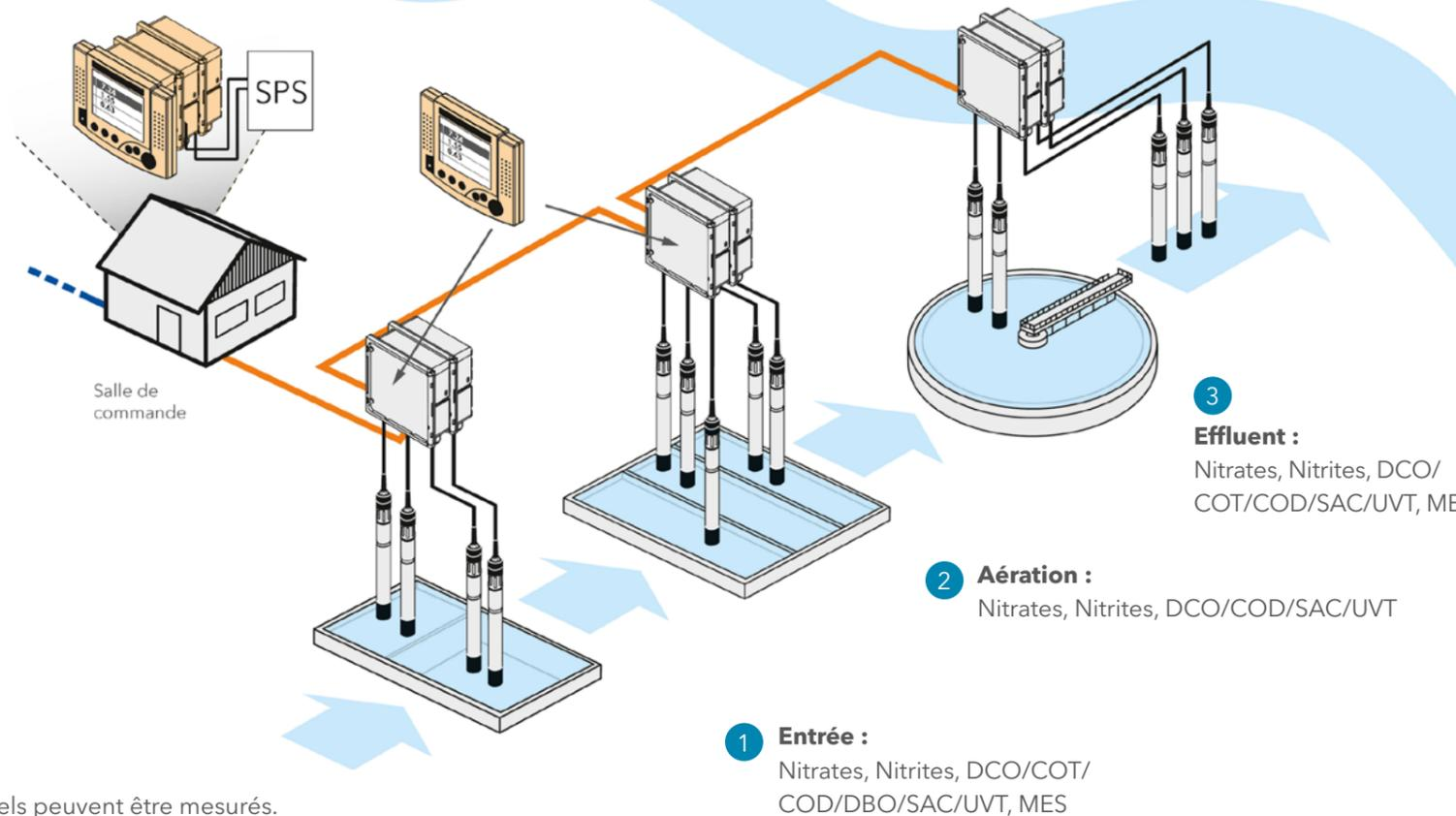
Les sondes à analyse spectrale en un coup d'œil :
