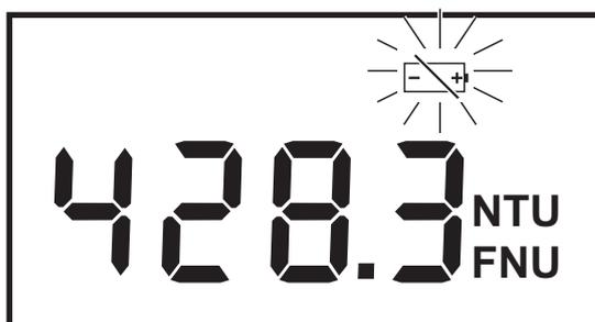
Les piles sont presque épuisées et il faut bientôt les changer. L'appareil mesure encore avec la précision indiquée.
