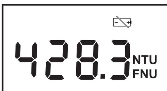
Dans ce cas, changez les piles immédiatement. Il est possible que la précision de mesure ne corresponde plus aux spécifications. Lorsque les piles sont trop faibles pour mesurer, le turbidimètre s'éteint automatiquement. Il ne pourra alors être rallumé que lorsque les piles auront été changées.
