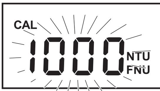
3 Insérer l'étalon de calibration 1000 NTU/FNU dans le puits à cuve de sorte qu'il s'encastre.
