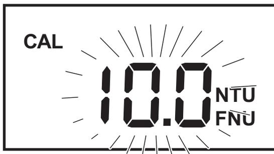
5 Insérer l'étalon de calibration 10,0 NTU/FNU dans le puits à cuve de sorte qu'il s'encastre.
