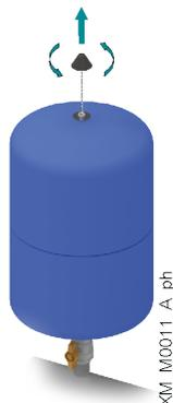
3. Aplique el manómetro a la válvula y compruebe la presión.
