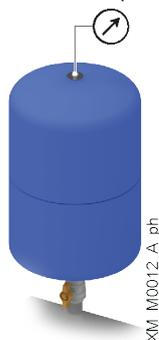
4. Retire el manómetro y enrosque el tapón.
