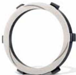
**LA TECHNOLOGIE ACTIVE SEAL** de Flygt améliore la fiabilité de la garniture du fait que la garniture interne du système à garniture double agit comme une micropompe. Les rainures en spirale, usinées au laser dans la face intérieure du joint, pompent continuellement du liquide de l'intérieur vers l'extérieur de l'anneau, empêchant ainsi toute entrée de liquide dans le moteur.
