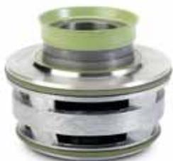
**LES GARNITURES PLUG-IN™ FLYGT** consistent en deux garnitures mécaniques indépendantes (interne et externe), montées dans une seule unité prête à l'installation. Aucun outil spécial n'est requis pour l'installation et un dispositif intelligent protège les surfaces d'étanchéité sensibles et les ressorts contre les impuretés. Certaines versions intègrent notre technologie brevetée et d'étanchéité Active Seal.
