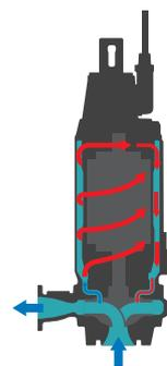
**Sistema de enfriamiento de circuito abierto con el medio bombeado circulando alrededor del motor**
