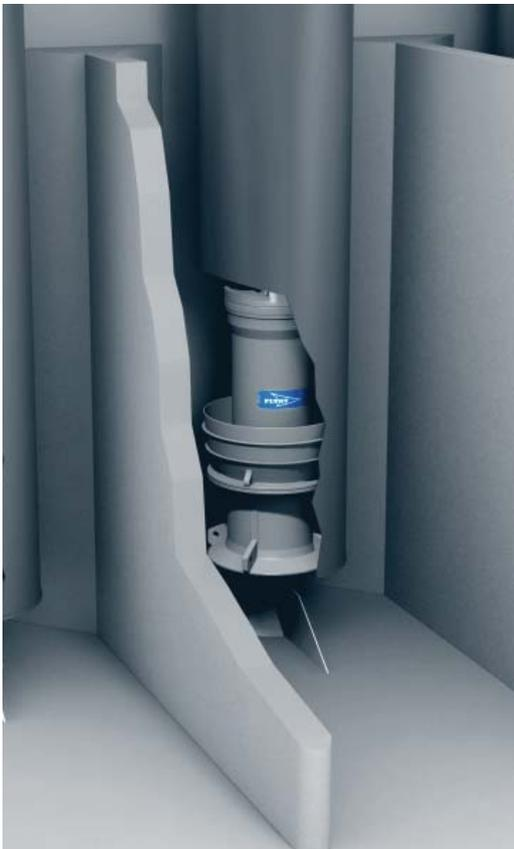
Este diseño de compartimento de entrada a las bombas es más sensible a las aproximaciones no uniformes. Si se utilizan para más de tres bombas, la longitud de las paredes divisorias debe ser al menos  $2/3$  de la ancho total del foso.
