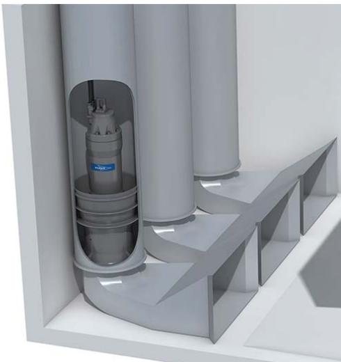
La toma de succión FSI (Formed Suction Intake, FSI) patentada de Flygt es un dispositivo versátil y fácil de usar que se puede acoplar a la succión de bombas axiales instaladas verticalmente. Esta toma incorpora las ventajas de la toma cerrada y simplifica el diseño del compartimento de bombeo, reduciendo de forma importante la magnitud de las obras civiles de la estación.
