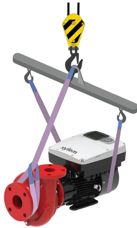
Métodos de elevación aceptables para los modelos de aspiración final con acoplamiento cerrado e-1531X y e-1532X
