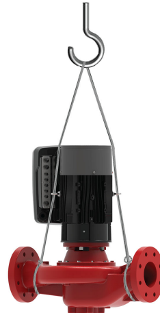
Métodos de elevación aceptables para los modelos de aspiración final con acoplamiento cerrado e-1531X y e-1532X
